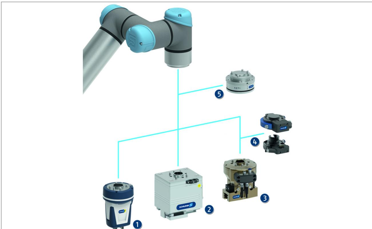
Все компоненты Plug & Work подготовлены для прямого механического и электрического подключения к роботам Universal Robots типоразмеров 3, 5, 10 и 16. В зависимости от требований можно выбрать различные захваты и исполнительные компоненты. Пневматические хватные блоки дополнительно оснащены микроклапанами, что означает, что внешние клапаны не требуются.
